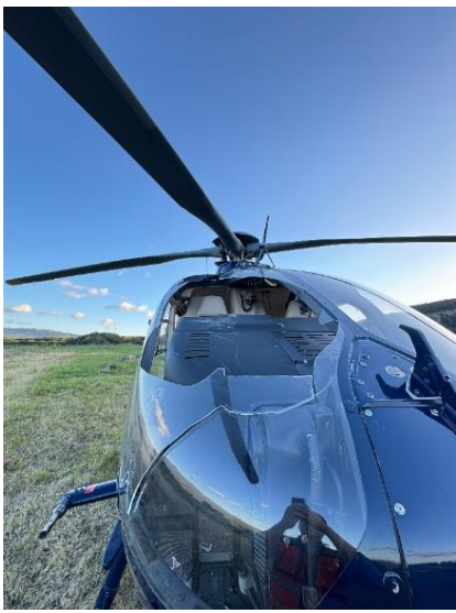
Fig.2- Imagen de daños en el parabrisa.
